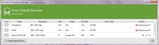
Anschließend erscheint das neue virtuelle Gerät in der Liste und kann über das Bleistift-Symbol bearbeitet und über das Pfeil-Symbol gestartet werden. Der Start des AVD kann mehrere Minuten dauern.
