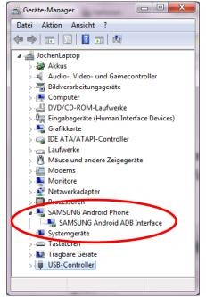
Die Kommunikation mit angeschlossenen Tablets wird von der *Android Debug Bridge (ADB)* erledigt. Über die ADB können wir unsere selbst erstellten Android Apps auf ein Android Gerät übertragen und installieren.
