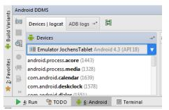
Wenn die AVD läuft, ist sie im Fenster *Android* unten als Device sichtbar. Dann kann die App über  $Run \rightarrow Run \dots$  gestartet werden. Der Vorgang kann ein Weilchen dauern.
